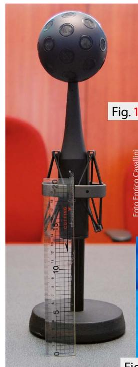
Fig. 1 - Sonda Microfonica H.O.A.
