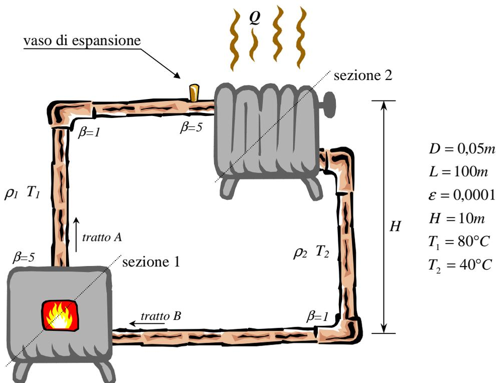
Il condotto del sistema è un tubo in ghisa molto grosso, rispetto ai tubi utilizzati nei normali impianti domestici, infatti, l'impianto a circolazione naturale non necessita dell'utilizzo di una pompa per far circolare l'acqua; il motore del sistema è la differenza di temperatura ( $\Delta T$ ) tra la temperatura dell'acqua che esce dalla caldaia ( $T_1$ ) e la temperatura dell'acqua che esce dal corpo scaldante ( $T_2$ ).
