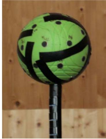
**Figure 5.8** – Prototype de microphone HOA d'ordre 4 constitué de 32 capteurs omnidirectionnels répartis sur une sphère en plastique rigide suivant les 32 sommets d'un pentaki-dodécaèdre.
