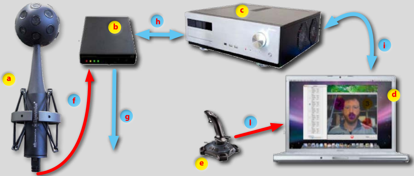
Fig. 7 – Componenti hardware del sistema. a Sonda microfonica, b interfaccia EMIB, c Unità di elaborazione dei segnali, d console di controllo (notebook), e dispositivo di puntamento (joystick); f cavo CAT 6, in questa applicazione può operare fino ad una lunghezza di 140 m, g interfaccia ottica ADAT, h interfaccia firewire, i collegamento via cavo Ethernet CAT 5 o WiFi, l collegamento via cavo o wireless.
