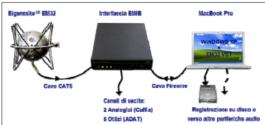
Figura 7: composizione del sistema Eigenmike (TM)
