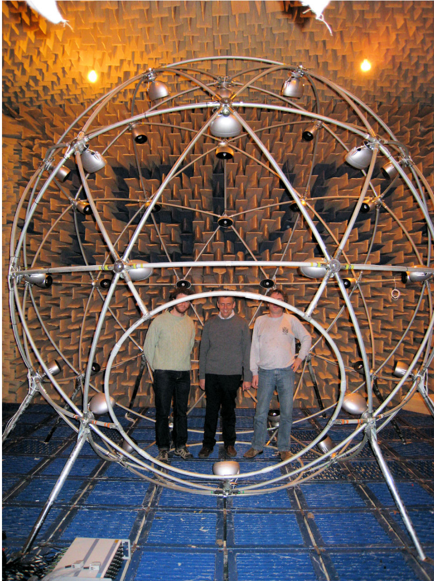
Fig. 21 – il sistema di riproduzione sonora sviluppato all'ISVR
