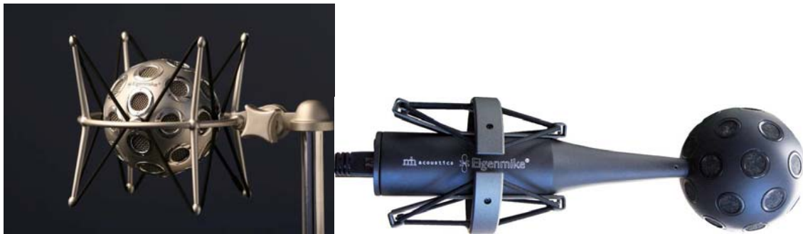
Figura 6: prima e seconda versione della sonda Eigenmike (TM)
