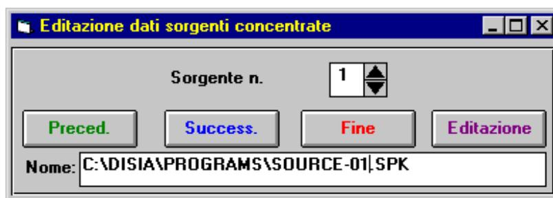
Dopo aver inserito i dati di tutte le sorgenti, si creano i files di input per Disiapyr, in formato .RAY (è un formato ASCII, utilizzato anche da altri programmi di calcolo). Per far ciò è necessario specificare il piano di mappatura e la risoluzione della griglia di ricevitori, nonchè ovviamente il nome del file:
