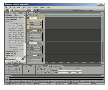
Un segnale di prova si può ottenere generando un sine sweep che parte con una frequenza di 40 Hz e termina con frequenza pari a 2000 Hz, una durata di 15 sec, fade-in di 0.5 Hann e fade-out 0.2 Hann.
