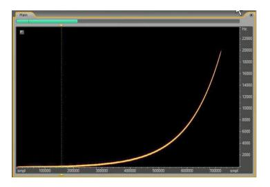
Utilizzando tre tracce: traccia 1 sweep, traccia 2 registrazione WX e traccia 3 YZ, ottengo degli spettri in cui si nota la "sweepata" principale mediante un sonogramma. Attraverso questo è possibile rappresentare un fenomeno a tre dimensioni (frequenza, ampiezza e tempo) su un supporto bidimensionale. La registrazione dell'altoparlante presenta dei prodotti di distorsione, che sono facilmente visibili aumentando il range a 180 dB.
