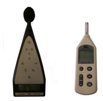
Il fonometro misura il livello del valore quadratico medio della pressione sonora (Lp) espresso in dB.
