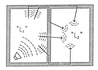
La misura viene svolta in stanze confinanti di appartamenti di diversa proprietà. Viene posta una sorgente (dodecaedro) nella stanza trasmittente e un cavalluccio con fonometro, prima in una poi nell'altra stanza ( $L_1$  e  $L_2$ ). Essendo una struttura unica sono presenti cammini di fiancheggiamento che peggiorano il valore della misura. Il potere fonoisolante misurato in opera è dai 3 a 5 dB peggiore del valore misurato in laboratorio.
