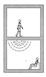
Riguarda la trasmissione per via solida del suono che si genera quando si cammina sul pavimento.
