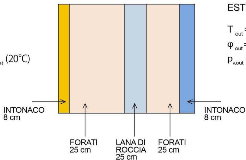
Dal punto di vista TERMICO abbiamo 5 strati conduttivi e 2 strati convettivi (aria in e out) per un totale di 7 resistenze termiche.
