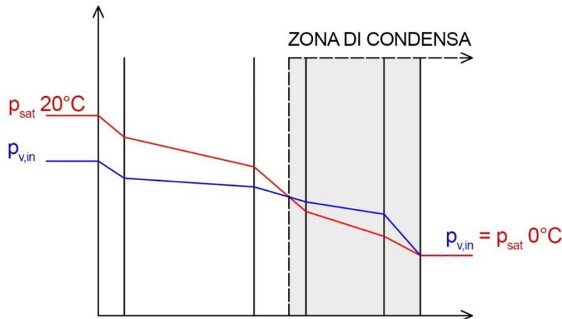
Le soluzioni adottabili per impedire la condensa interstiziale sono ad esempio l'aggiunta di un cappotto esterno che rivesta interamente l'edificio, altrimenti l'aggiunta di una barriera al vapore posizionata verso la parete interna degli ambienti che impedisca la perdita di vapore dall'interno.
