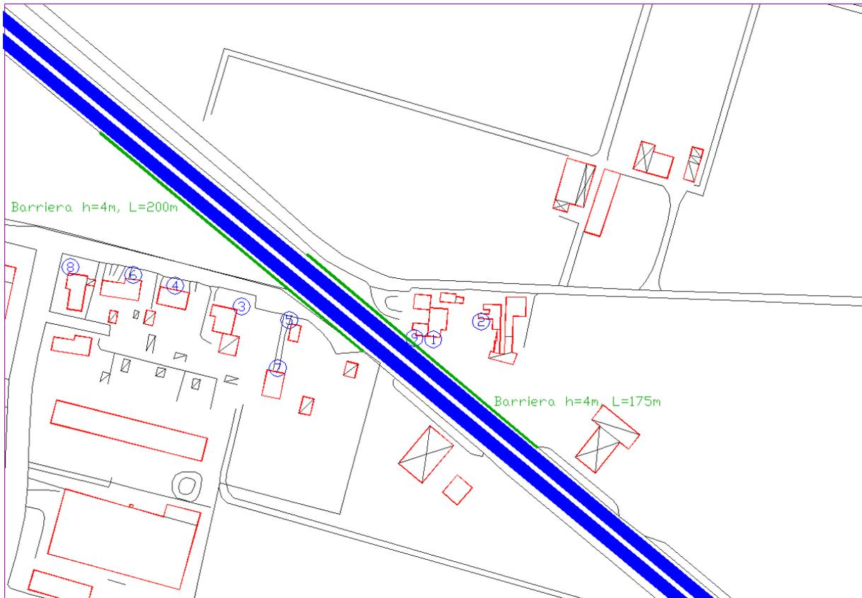
Si nota che sono stati previsti due tratti di barriera antirumore “sottile” alta m 4.00 e con lunghezza rispettivamente di m 175 e m 200. Il posizionamento di precisione del piede delle schermature andrà verificato mediante sopralluogo celerimetrico, onde evitare intersezioni con manufatti, cordoli, etc, e rispettando i confini del sedime stradale, senza necessità di invadere aree private.
