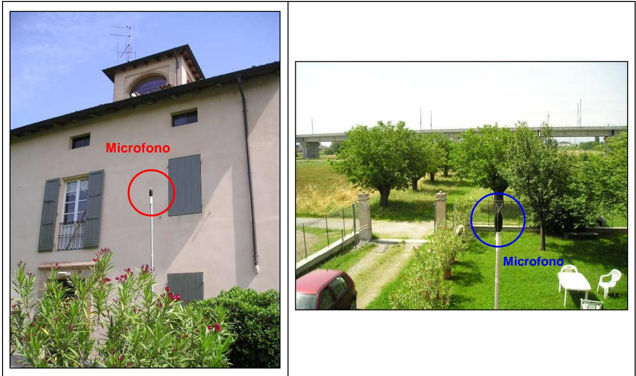
Fig. 1 - Postazione di misura presso il recettore.
