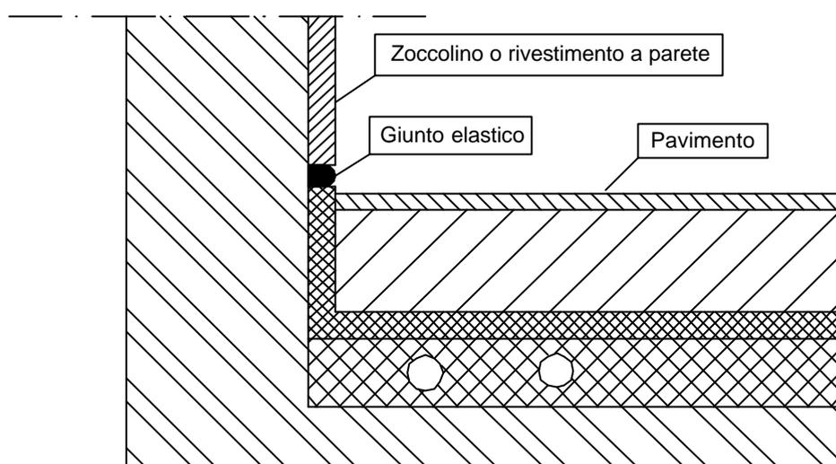
Anche nel caso vengano utilizzati **sistemi di riscaldamento a pavimento** (pavimento radiante) dovrà essere garantita la continuità della desolidarizzazione tra massetto galleggiante e partizioni esterne.
