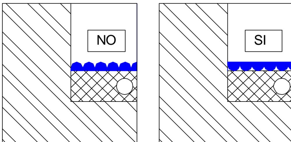
Il massetto in calcestruzzo sul quale andrà posata la pavimentazione dovrà avere densità elevata (minimo 80 kg/mq) e spessore minimo di 5 cm.
