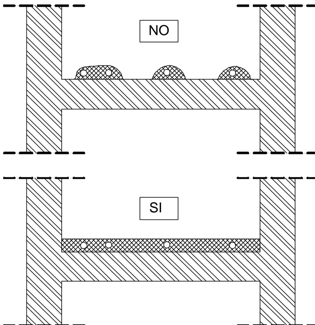
Nel caso la copertura degli impianti venga realizzata utilizzando massetti alleggeriti è necessario verificare che gli stessi siano omogenei. Eventuali concentrazioni di materiale per alleggerimento potrebbero determinare crepe o spaccature che vanificherebbero l’isolamento al calpestio.
